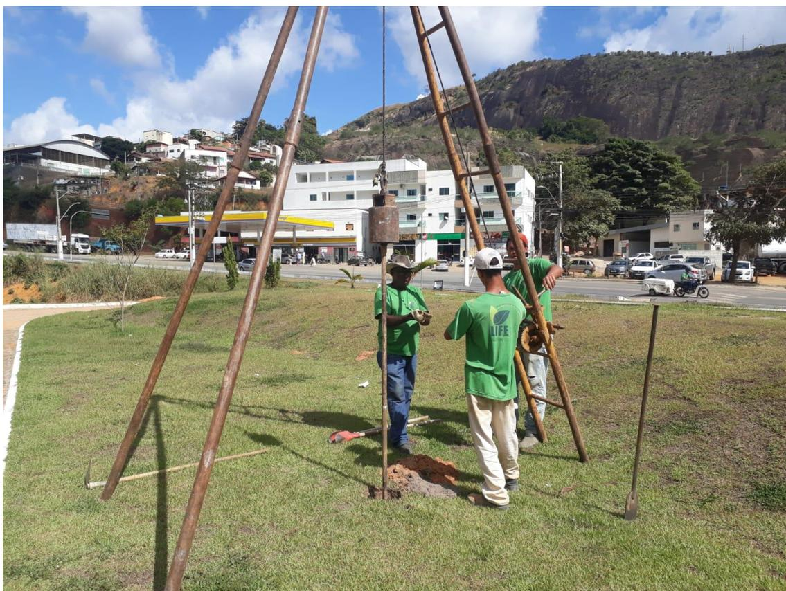
Imagem 02: Evidencia o recolhimento de amostras e análise no laboratório da empresa no SPT - 02.
